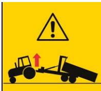
Figuur 23. Waarschuwing - Als de trekker aan de achterkant omhoog komt, is er sprake van een gevaarlijke beweging.
